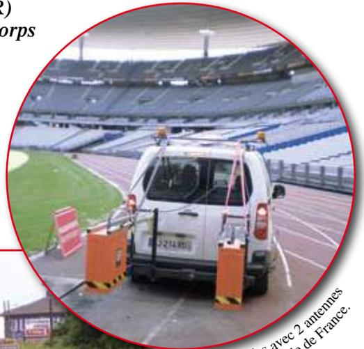
Mesures réalisées avec 2 antennes de 1 et 2,2 GHz au Stade de France.
